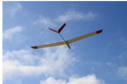
Die Spannweite beträgt wegen der handelsüblichen Leistenlänge ziemlich genau 2 Meter, plus Randbögen. Die Tragfläche hat einen Kohle-Rohrholm und ein SD 3021 Profil. Das Modell ist ein, ohne Empfänger, 540 Gramm leichter Zweiachser und fliegt sowohl am Gummiseil als auch am Hang bis maximal Windstärke 3 wunderbar. Auch hier sind die V-Leitwerksteile einzeln abnehmbar und die Tragfläche wird nach Altvätersitte mit Gummiringen auf den Rumpf geschnallt.
